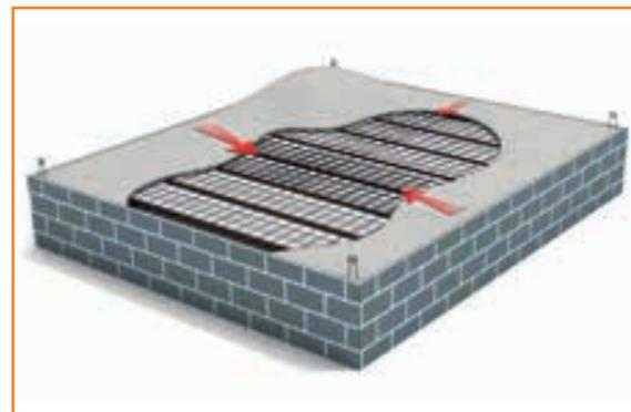
**6** Coulage de la table de compression. Répartir le béton en partant des appuis vers le centre des poutrelles.
