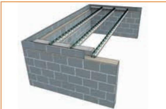
**3** Positionnement des poutrelles suivant le sens de répartition.
