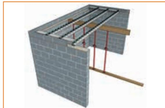
**4** Etalement du plancher à l'aide d'une lisse de répartition.
