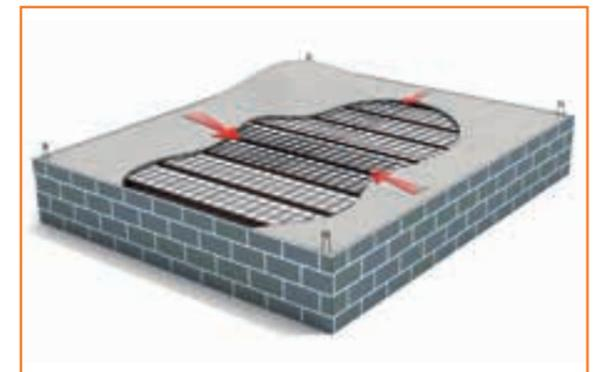
**5** Coulage de la table de compression. Répartir le béton en partant des appuis vers le centre des poutrelles.
