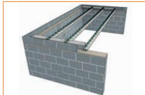
**3** Positionnement des poutrelles suivant le sens de répartition. Réglage de l'entraxe à l'aide des entrevous en abouts. Mise en place des entrevous.
