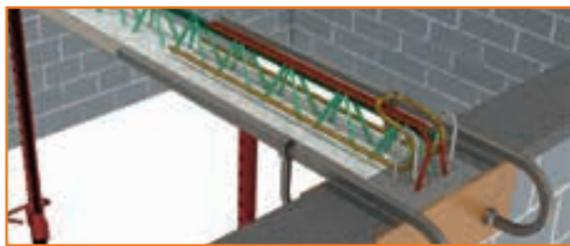
**5** Coffrage + clavetage de la poutre.
